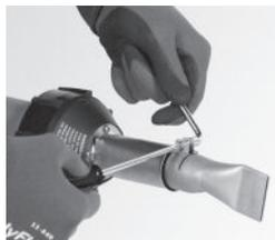
1. Lorsque l'appareil est complètement refroidi, se munir de gants, d'un tournevis cruciforme et d'une clé, afin de dévisser l'écrou de serrage situé en partie basse de la buse.
