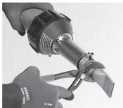
**2.** Afin de procéder au retrait de la buse, maintenir la buse avec une pince et effectuer un mouvement de rotation pour détendre la partie basse de la buse.
