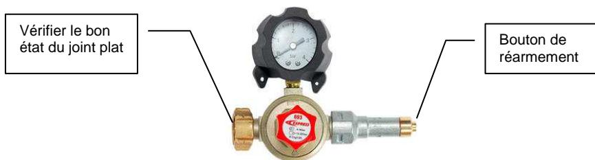
Il existe des versions d'appareils pour les bouteilles étrangères, nous consulter. Les bouteilles de faible capacité (5 kg) ne permettent pas un débit suffisant pour une utilisation normale. Ouvrir le robinet de la bouteille de gaz. Armer le détendeur en appuyant quelques secondes sur le bouton. Vérifier l'étanchéité des raccords (robinet/bouteille, entrée du pistolet) à l'aide d'une solution d'eau savonneuse. **ATTENTION** : ne jamais utiliser une flamme pour détecter des fuites éventuelles.
