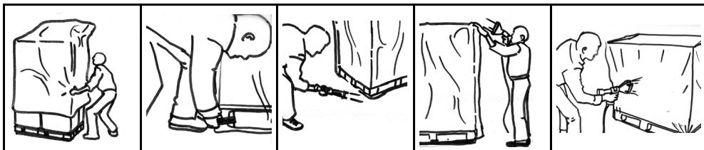
Les quatre coins de la palette à rétracter doivent être libres et par conséquent il importe de surélever les palettes à l'aide d'une autre palette ou mieux, d'un support robuste.
