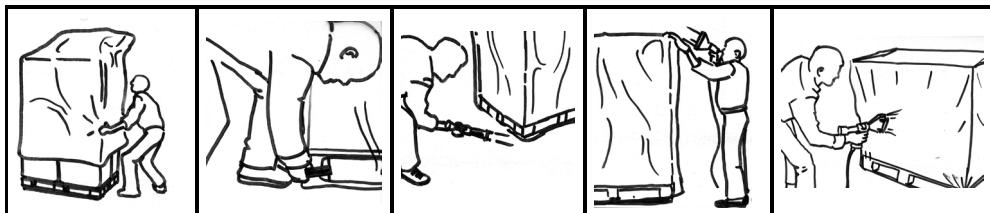
De vier hoeken van de pallet waarover de krimphoes wordt aangebracht moeten vrij zijn en daarom moeten de pallets omhoog worden gebracht met een andere pallet of met een andere stevige ondersteuning.
