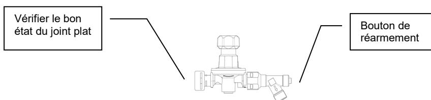
Il existe des versions d'appareils pour les bouteilles étrangères, nous consulter. Les bouteilles de faible capacité (5 kg) ne permettent pas un débit suffisant pour une utilisation normale. Ouvrir le robinet de la bouteille de gaz. Armer le détendeur en appuyant quelques secondes sur le bouton. Vérifier l'étanchéité des raccords (robinet/bouteille, entrée du pistolet) à l'aide d'une solution d'eau savonneuse. **ATTENTION** : ne jamais utiliser une flamme pour détecter des fuites éventuelles.
