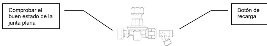
Existen varios modelos para las botellas fabricadas en otros países, consúltenos. Las botellas con capacidad muy limitada (5 kg) no ofrecen el caudal suficiente para un uso normal.
